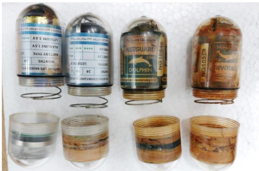
**Figura 24.** Pingers destruidos por golpes y por filtración de agua.
