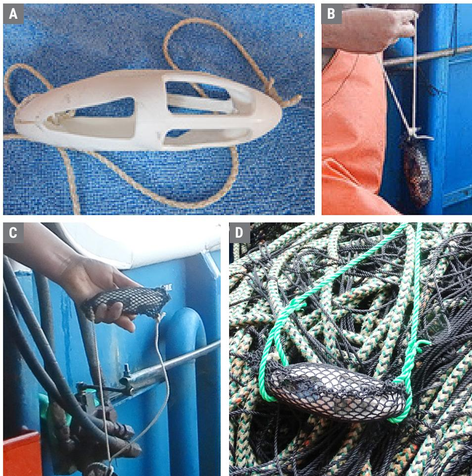
**Figura 23.** A) Cabo blanco de fábrica y carcasa de protección del pinger. B) Pinger en saco de malla y con cabo atado en un extremo. C) Pinger en saco de malla y con cabo amarrado en ambos extremos para mantener la posición horizontal. D) Pinger con cabo trenzado de propileno.
